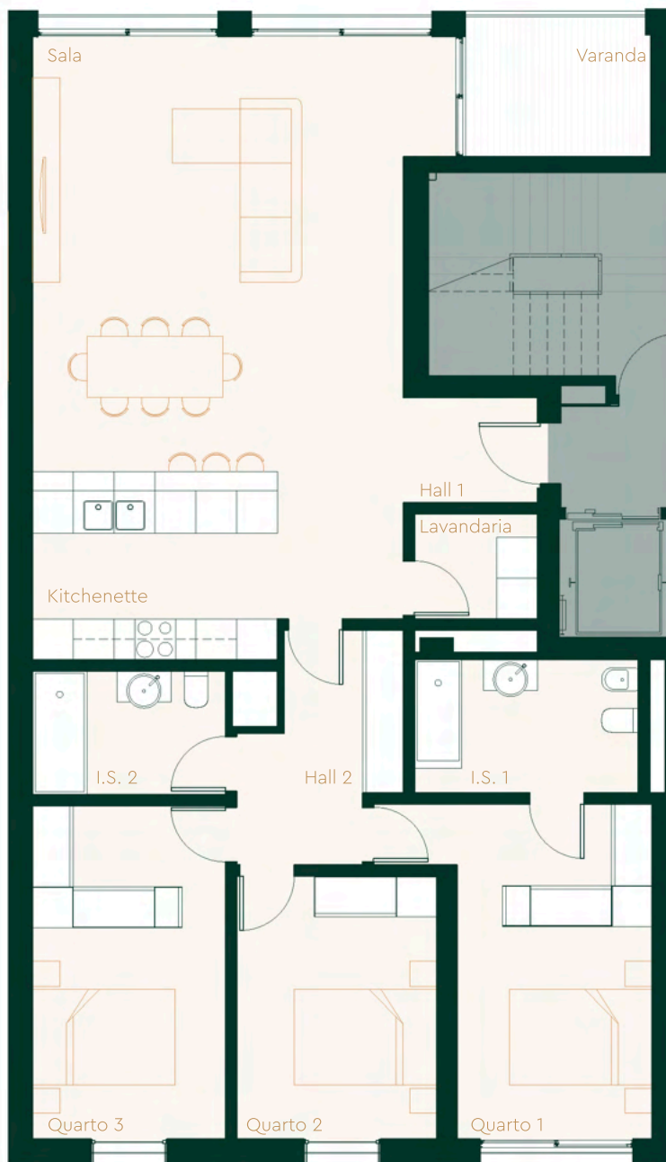
Planta da Fracção O . Escala 1:100
